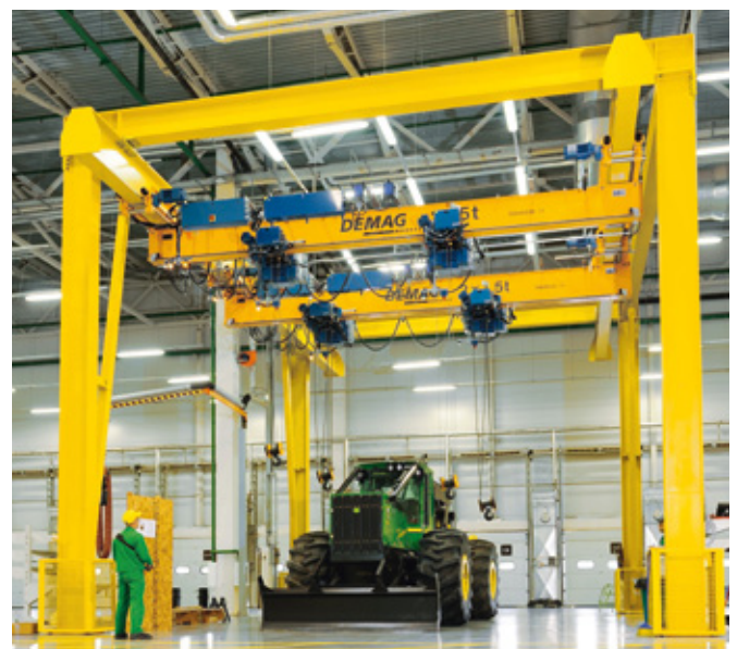
Demag Deckenkrane im Tandembetrieb in einer Montagelinie für Traktoren Потолочные краны Demag в тандемном режиме на конвейере сборки тракторов
