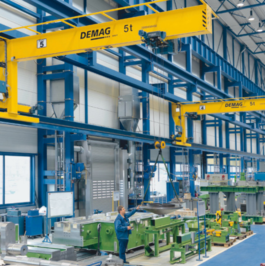
Demag Prozesskran für den Transport von Werkzeugen in einem Presswerk der Automobilindustrie Технологический кран Demag для транспортировки рабочего инструмента в штамповочном цеху автомобильного завода
