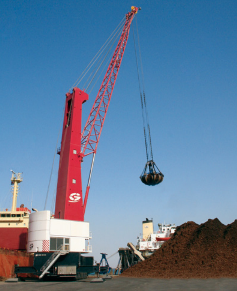
Gottwald Hafemobilkran der Generation 5 für den professionellen Schüttgutumschlag Портовый мобильный кран Gottwald 5 поколения для профессиональной перевалки сыпучих грузов.
